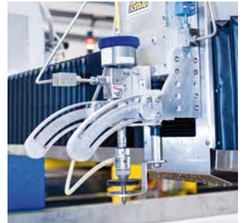
MBD - Manual Bevel Device Supporto per l'inclinazione manuale della testa per tagli lineari cianfrinati a V. Cutting head support with swivel device to cut linear V bevel.
