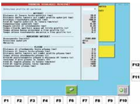
MTD - Material Technological Database Database completo di libreria materiali in grado di gestire automaticamente i parametri di taglio e il dosaggio ottimale dell'abrasivo in base alla qualità di taglio impostata. Permette di massimizzare le prestazioni della macchina con la semplice selezione del materiale e del relativo spessore. Data Base in order to set automatically the cutting parameters such the abrasive federate, water pressure, cutting speed, kerf compensation, ecc by simply selecting the material to be cut and the wished class quality (Q1, ..., Q5) from the relevant library in the CNC.
