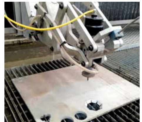
DBX - Dynamic Bevel 5 Axis Testa Bevel per tagli a smusso in ciclo automatico e possibilità di utilizzare la stessa per la compensazione dell'angolo di spoglia per ottenere tagli perfettamente diritti. Inclinazione automatica testa: + - 45° su singolo asse. Water Jet 5 axis head for automatic bevel cut and additional feature of angle correction when using the head as a vertical cut. Automatic bevel angle : + - 45° on each axis.
