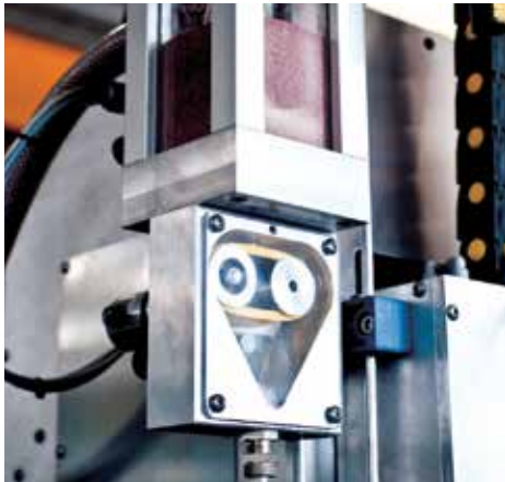
CAF - Controlled Abrasive Feeding System Mini Hopper di dosaggio controllato dell'abrasivo. Opera in sinergia con la tecnologia MTD. Mini Hopper with controlled abrasive feeding rate as per MTD.
