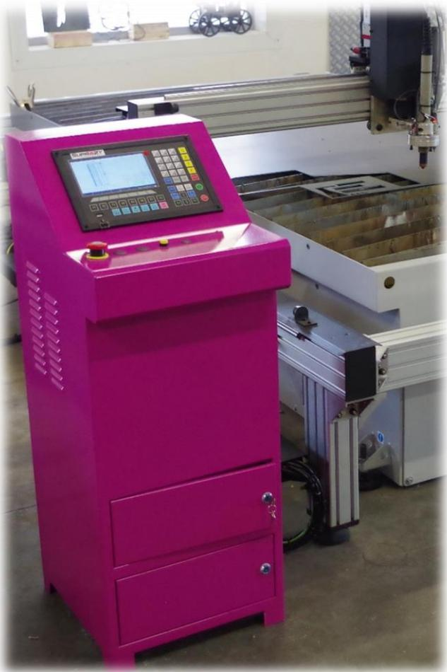
Indépendant du portique, le pupitre de commande contient les organes d'alimentation, le coffret de gestion d'arc, les modules d'asservissement des axes, et la commande numérique.
