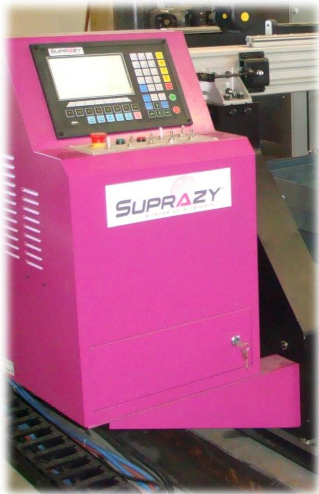
Le pupitre de commande contient les organes d'alimentation, le coffret de gestion d'arc, les modules d'asservissement des axes, et la commande numérique. Il est solidaire du bâti gauche du portique.
